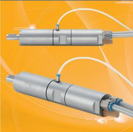
DEPRAG Edelstahlmotoren mit integrierter Haltebremse sind aufgrund ihrer Technik und Baugröße optimal für alle Einsatzbereiche, in denen Sicherheit eine wichtige Rolle spielt, geeignet. Die integrierte Bremse wird wahlweise über eine separate Steuerleitung oder direkt über die Motorabluft angesteuert. Fällt der Druck ab, wird die Bremse automatisch aktiviert.
