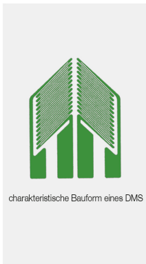
Funktionsprinzip unserer Dehnmessstreifen Aufnahme
