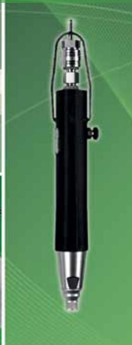
La visseuse MINIMAT-T est équipée d'un palpeur réglable qui actionne le limiteur de couple et permet une profondeur de vissage constante. Cette visseuse est disponible en modèle droit ou à poignée pistolet, avec un couple maximal de 5 à 12 Nm.
