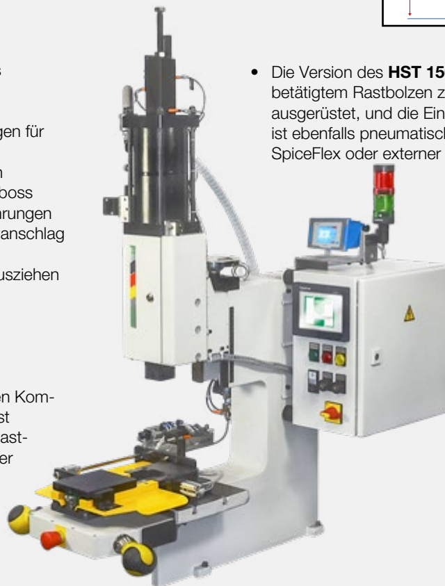
HST 150 PPR in Arbeitsstellung mit pneumatisch betätigtem Rastbolzen mit pneumatisch betätigter Ein- und Ausfahrbewegung
