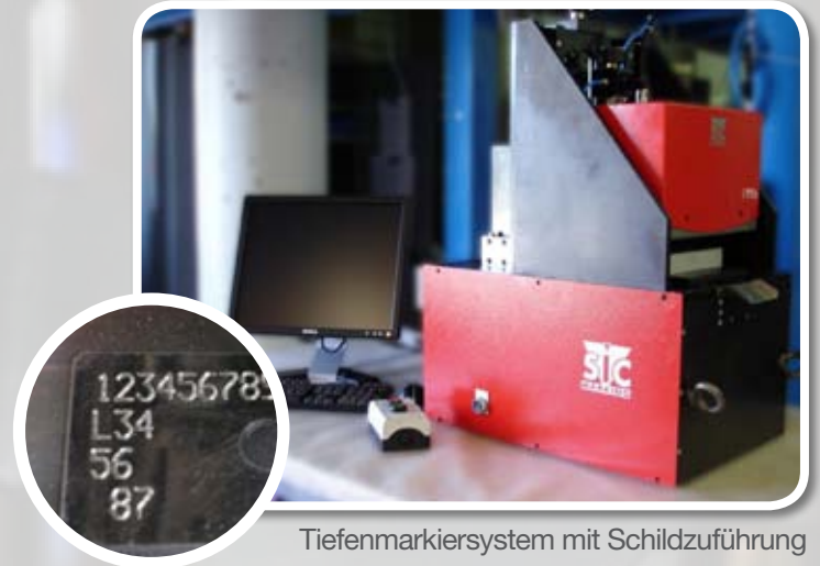
Höchst kompakter automatischer Lader (A4 Format)
