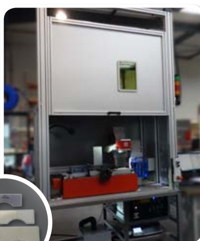
Multiformat-Ladesystem mit automatischem Stapler
